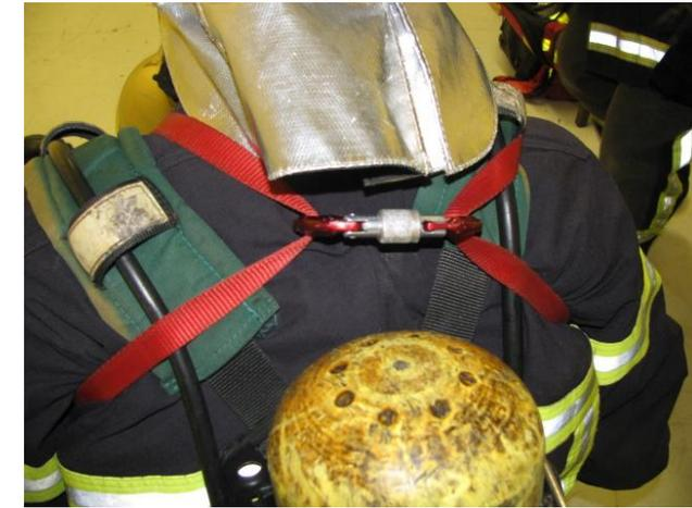
Verrouillage au moyen d'un mousqueton sur **l'avant** du sauveteur
